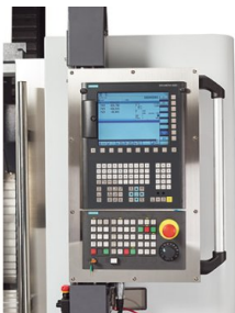
Siemens Sinumerik 828D con ShopMill
