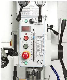
Regolazione velocità mediante cambio manuale ed inversione del senso di rotazione del mandrino attivata da interruttore sull'arresto di profondità
