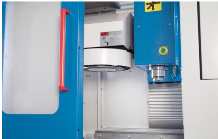
Il cambiautensili a 12 posizioni per produttività e flessibilità
