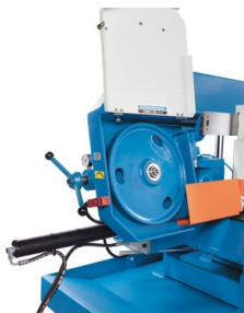
Un manometro garantisce la corretta tensione della lama
