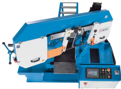
Il telaio della sega può essere ruotato fino a 45°
