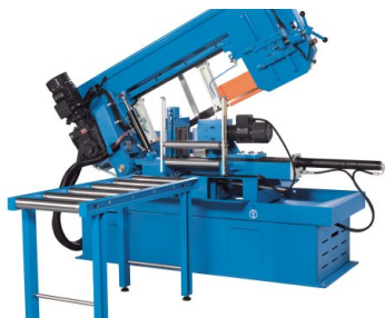
Il convogliatore a rulli di avanzamento è incluso nella dotazione standard
