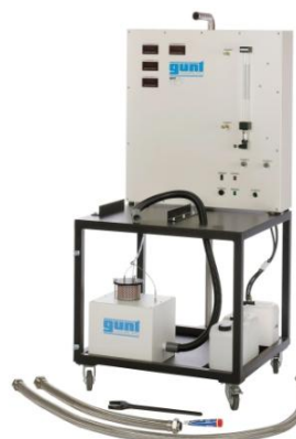
CT 159 Banco di prova modulare per motori monocilindrici, 3kW
